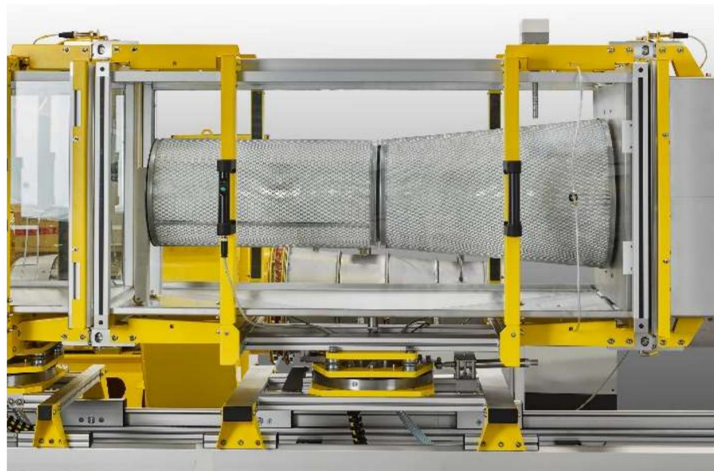
GTS-114 的过滤器安装支架
