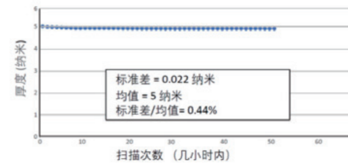
玻璃基底 (BK7) 上 5 纳米 Al 2 O 3 膜厚测量稳定性
