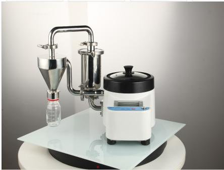
一、产品介绍气流筛运用空气动力筛分，防止团聚，样品分散好，专为低密度且易团聚的细微颗粒的筛分分析所设计。适配于孔径为10微米及10微米以上的分析筛。筛网进行特殊非金属化处理，喷嘴速度可调，筛分灵活，平均筛分时间为2-3分钟。可与手动可调的工业抽气设备连用，或选配自动抽气设备，持续的气流保证筛分过程的可...
