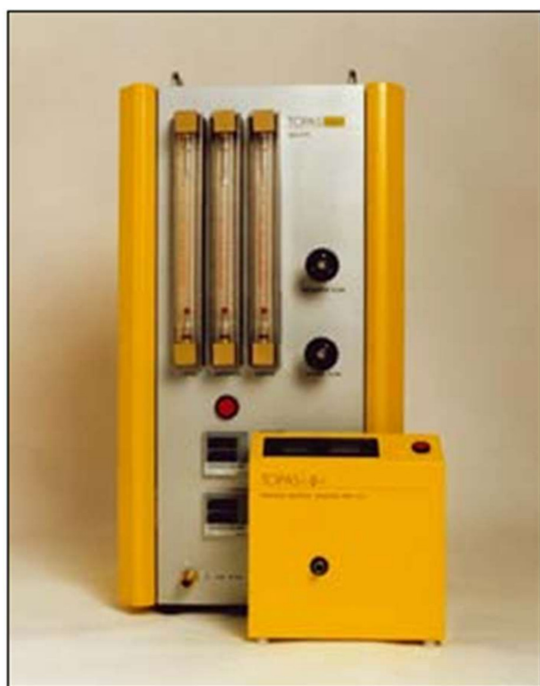
监测由凝聚式气溶胶发生器 SLG-270 (Topas) 生成的单分散气溶胶
