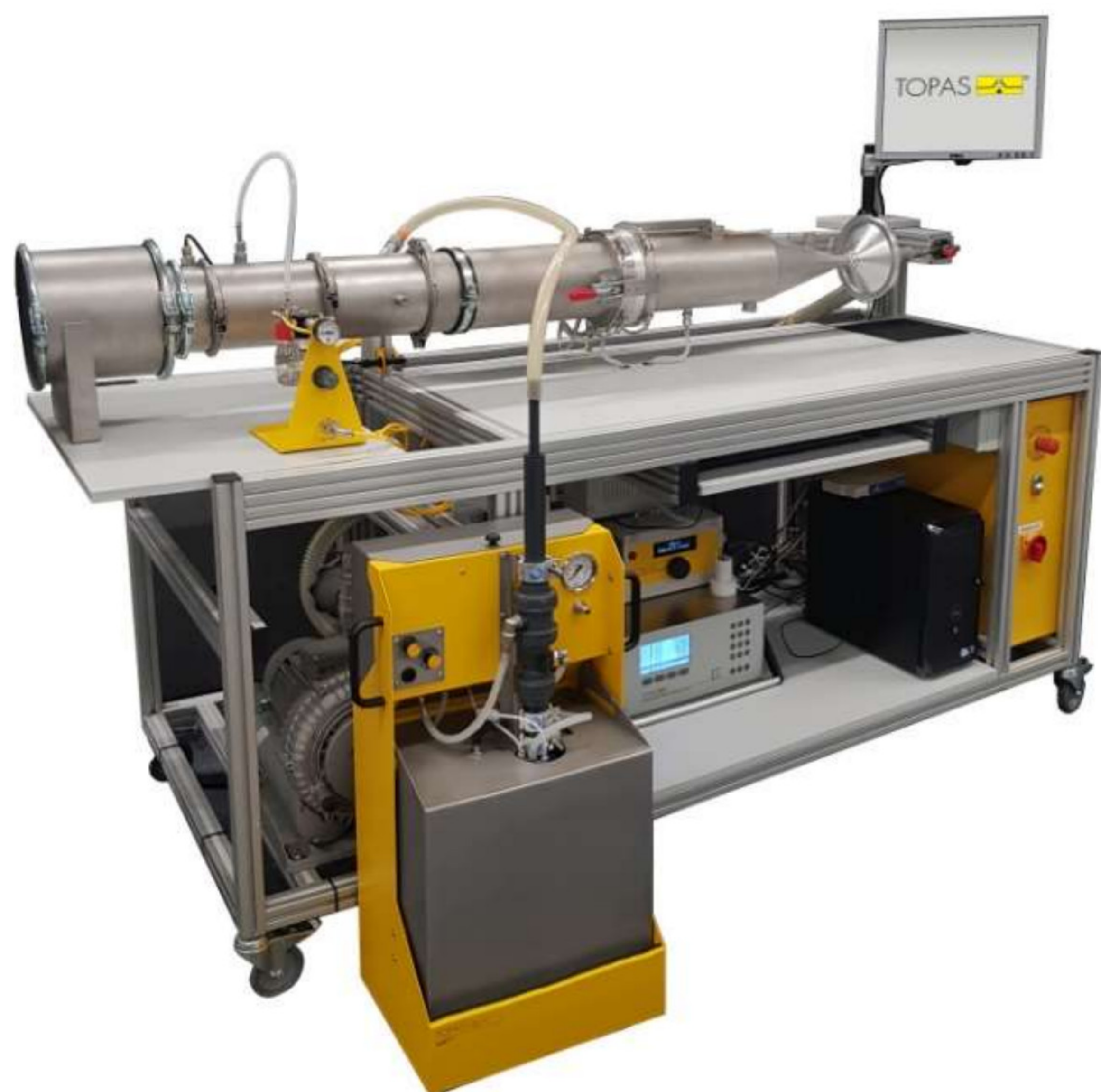
AFC-132 滤料测试系统符合 ISO 16890 标准
