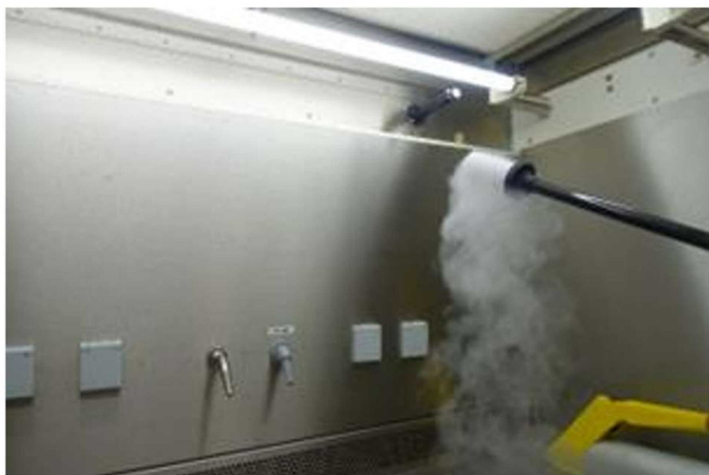
通过 CFG-291 的单点探头排放雾气
