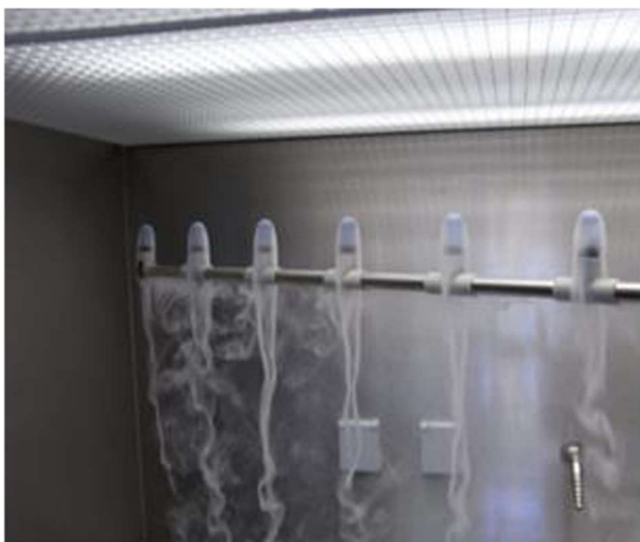
使用 CFG-291 的排气格栅进行雾气的排放
