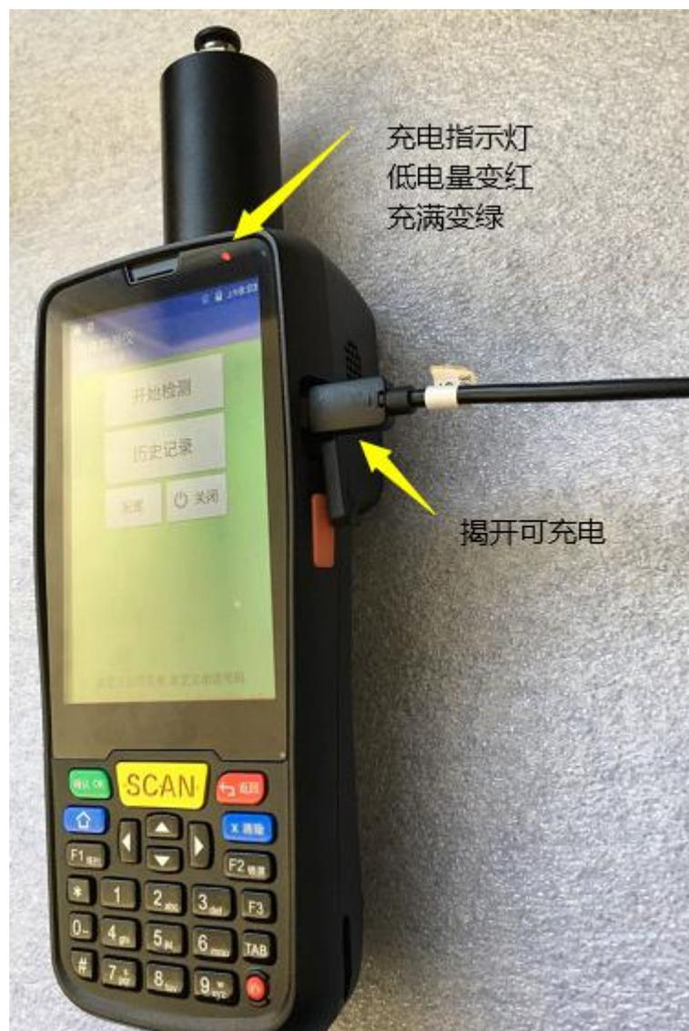
本产品配备的是 2800mAH 的防爆型锂电池，连续开机检测可以达 6-12 个小时（视屏幕亮度和功能决定）。在每次检测完后，根据电量情况决定是否进行充电，建议小于 30%电量时，进行充电，确保下次有足够的电量。
