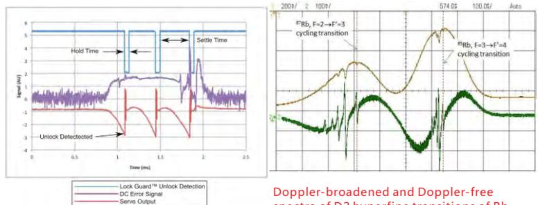
D2-125-PL-IP的峰值锁定功能提供调制信号，并解调具有可调相位的输入偏移信号。生成的第一个导数偏移信号（图中为绿色）允许在没有外部调制源和锁定放大器的过渡峰值锁定。
