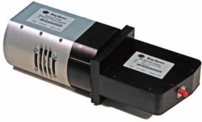
配备Nunavut™ 深冷近红外相机的 OEM 光谱引擎
