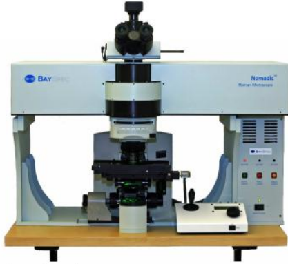
配备Nunavut™ InGaAs 探测器的共焦拉曼显微镜
