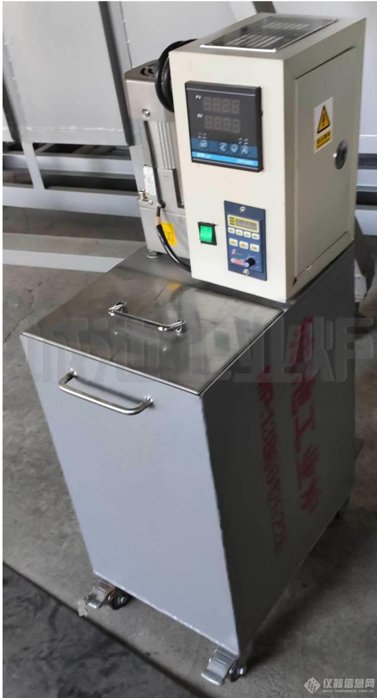
本淬火槽可选的铰接盖提供消灭任何潜在的淬火油火灾的手段，使淬火介质清洁。
