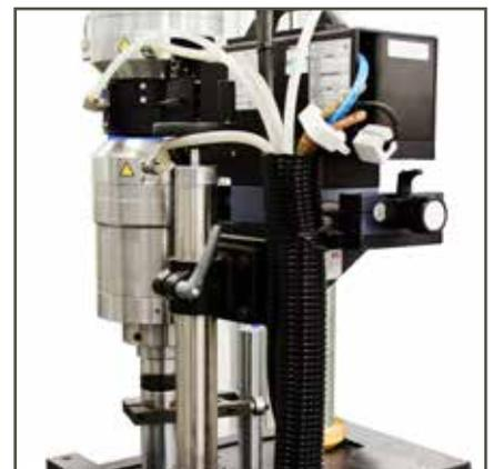
所示的模块化夹具带有楔形头，适合扁平试样
