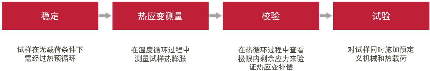
在单个专用软件中执行完整的试验可以节省时间，降低出现人为错误的几率。以下为该软件包含的附加特性示例：内置模量测量、自动计算试样参数、创建可视化试验波形和集成数据后续处理。
