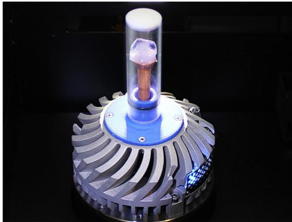
温控样品台可在温度变化环境中原位进行显微 CT 测量，以研究温度对物体的三维微观结构的影响。温控样品台可以实现从环境温度下降 40 摄氏度到上升 120 度的冷却和加热。通过 48MHz 内部微处理器，可以通过小于 1 度的精度精准控制温度范围。
