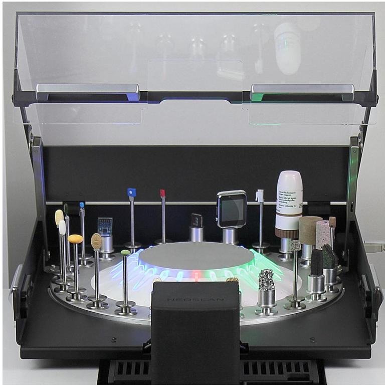
自动样品装置可实现样品的自动更换。它位于屏蔽区域外部，因此可以在不中断扫描周期的情况下取出已扫描的样品并加载新样品。
