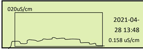
在曲线查询界面下：按“▲、▼”键，可以进行翻页查询；按“Sel”键，光标向右逐点移动；按住“Sel”键不放，光标向左或右快速移动；在光标移动的同时，界面上实时显示光标与曲线交叉处的被存储数据和对应存储时间；在此界面同时按下“▲、▼”键可进入曲线重置功能。
