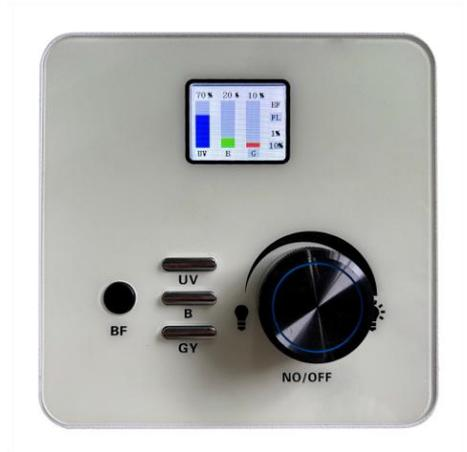
■**电动控制：**使用电机，通过控制器的按键可以电动一键控制在明场或不同通道荧光之间的转换。
