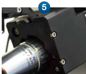
XYZ 物镜扫描器，将拉曼激光耦合到针尖尖端，移动范围 30\times 30\times 15\mu\text{m}
