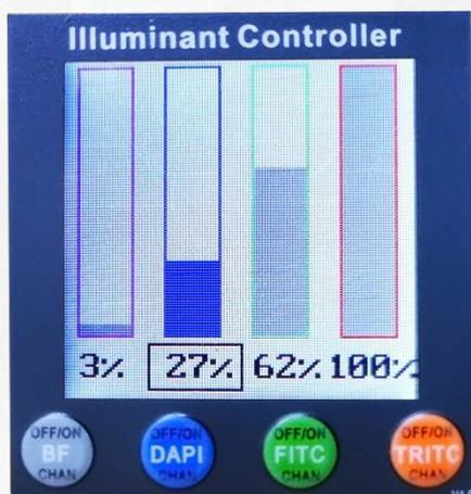
1.44 英寸彩色大屏，对应荧光颜色的方柱方式清晰显示每个通道的状态，百分比数值显示光强。
