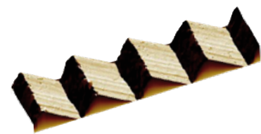
刻划光栅锯齿形刻槽轮廓
