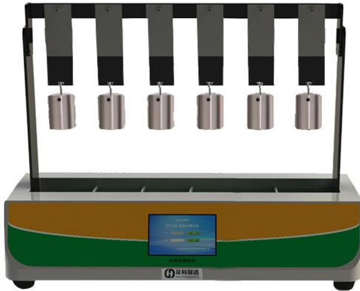
**CZY-6HB 持粘性测试仪**是一款智能型、触屏版仪器，其按照<<药典>>相关标准规定设计制造，适用于医用贴剂、膏药等产品进行持粘性测试试验。
