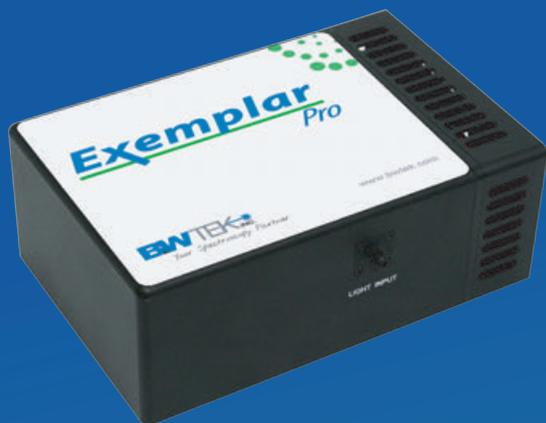
Exemplar® Pro (BTC675N) 是一款高性能的智能光谱仪，采用了低杂散光的非交叉型 Czerny-Turner。配备了高灵敏度，深度制冷(-25°C)的薄型背照式(BT)CCD 探测器，该探测器经过线性求和，具有较高的动态范围。通过较长的焦距和高量子效率的探测器相结合，可在整个 190nm-1100nm 的光谱范围内提供更优的数据质量。
