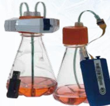
C-CIT在线葡萄糖/乳酸传感器系列产品是一种基于酶电化学原理的传感器系统，用于对细胞系、培养基和工艺开发项目过程中连续在线监测葡萄糖和乳酸。该传感器系统可在一定的时间（21天）范围内显示细胞培养的相关生长行为和代谢状态。数据生成频率为20秒/次，全天观察您的细胞培养状态。也可直接与OPC服务器连接，通过葡萄糖消耗和乳酸生成的在线监测来实现过程反馈控制。
