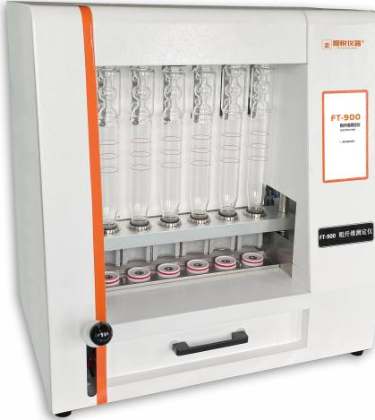
FT-900粗纤维测定仪是一款操作简单、应用灵活的纤维含量检测仪器，可用于传统的温德法检测粗纤维和范式法检测洗涤纤维。它是以酸碱洗涤法原理，集酸、碱处理及冲洗于一体，采用全封闭电加温、加液、消煮、抽滤、冲洗的方法来测定纤维含量。适用于植物、饲料、食品及其它农副产品中粗纤维的测定以及洗涤纤维、纤维素、半纤维素和其它相关参数测试，其结果符合GB/T5515、GB/T6434 的规定。
