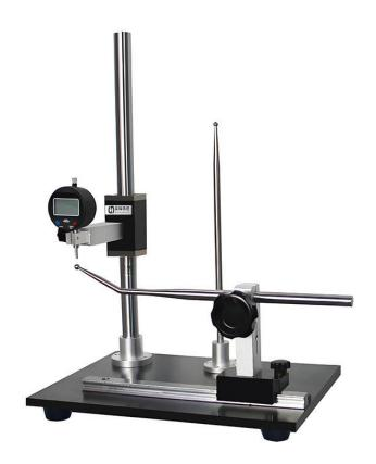
**DBH-021 底厚壁厚测量仪**,是按国家标准的规定,用于制药、食品、药品等行业,如:啤酒瓶、饮料瓶和医药行业安瓿瓶、口服液瓶、抗菌素瓶、输液瓶类及各类塑料瓶完成底壁厚检测用。
