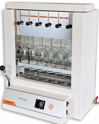
ST-600自动脂肪测定仪(索氏提取仪)是根据索氏抽提原理，集热浸泡、抽提、淋洗、溶剂回收、烘干于一体，对脂肪等有机物进行萃取分离的仪器。仪器采用了自动控温、全封闭井式电加热形式，使仪器加温更为均匀，安全可靠，并具有良好的密封设施，从而达到快速准确的目的；最大限度降低溶剂用量，自动回收溶剂，节省分析成本。ST-600脂肪测定仪具有设计合理、操作简单、精确度高、性能稳定、重现性好、省力、省时等优点。
