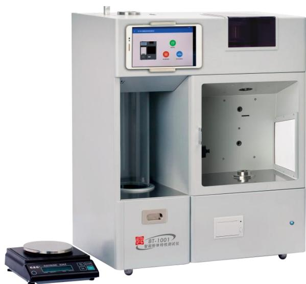
BT-1001智能粉体特性测试仪集成多种粉体测试技术，可自动分析粉末材料的物理特性，如休止角、崩溃角、差角、平板角、分散度、压缩度、孔隙率、松装密度、振实密度、均齐度、凝集度、流动性指数、喷流行指数、筛分粒度。它具有智能程度高、操作简便、测试速度快、重复性好、适合多种标准等特点。该仪器的研制成功和广泛投放市场，为国内外客户提供了一个科学的粉体物性表征手段。
