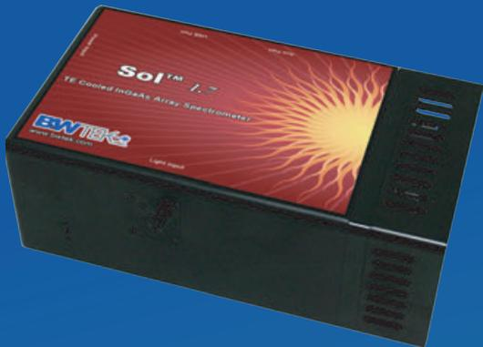
Sol™ 1.7 (BTC261P) 是一款高性能线性铟镓砷 (InGaAs) 阵列光谱仪, 探测器具有 512 个像元, 可提供很高的光通量和较宽的动态范围。TE 制冷可低至  $-5^{\circ}\text{C}$ 。
