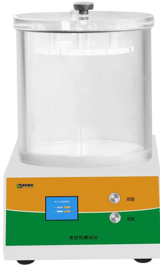
**MFY-01 密封性测试仪**采用负压法测试原理，适用于袋、瓶、罐、盒等包装件的密封试验。通过试验可以有效地比较和评价包装的密封工艺及密封性能，为确定相关的技术指标提供科学依据；也可用于经跌落、耐压试验后的某些包装的密封性能测试。
