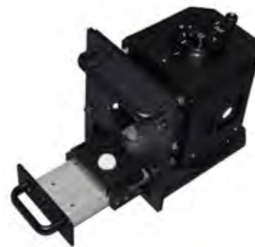
积分球 (光路直接耦合, 无需光纤)
