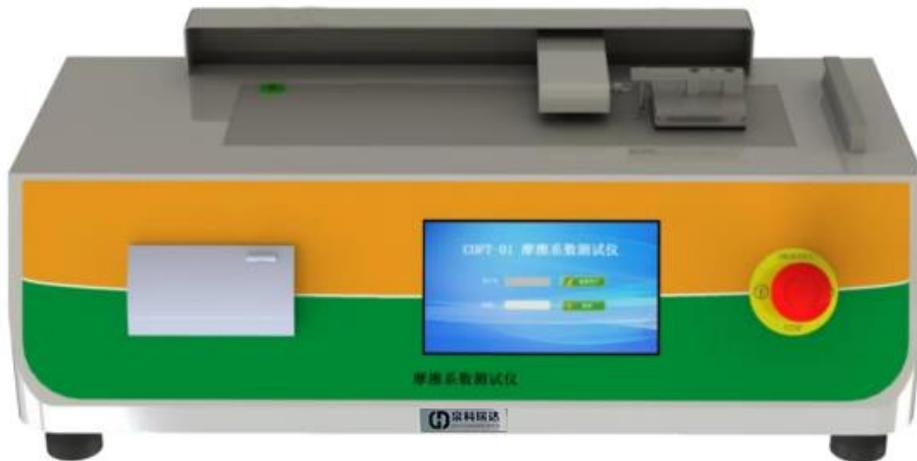
**COFT-01 摩擦系数测试仪**用于测量塑料薄膜和薄片、纸张、橡胶、编织袋、纸板、织物风格、输送带、通信光缆用金属材料复合带、涂层、木材、刹车片、鞋材、雨刷、轮胎等材料滑动时的静摩擦系数和动摩擦系数。通过测量材料的清爽性，可以控制调节材料生产质量工艺指标，满足产品使用要求。另外还可用于滴眼液、化妆品等日化用品的清爽性能测定。
