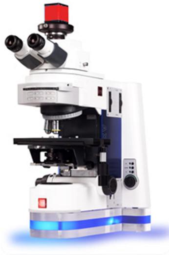
具有独特的多功能性系统设计能够允许用户只在一台显微镜上获得紫外-可见-近红外的高分辨率成像和分析结果。紫外显微镜对半导体内微量异物有很高的灵敏性, 相比标准的显微镜, 具有更强大的能力解决细节变化; 而近红外显微镜能够无损的、有选择性的对硅晶片设备内部的电子电路进行精确成像。这些应用只是其众多应用领域的一小部分, UVM-1TM 全光谱显微镜灵活的设计使其在任何应用领域都能做到完美、最优秀。
