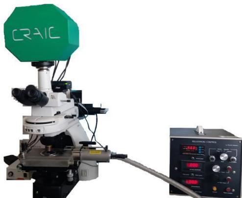
借助现代光纤光谱仪和高性能显微光学技术，将为阴极发光检测技术赋予新的效能：
