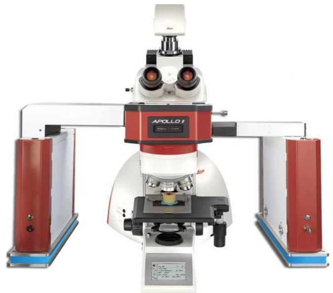
件（反射镜等），使到达样品的激光功率最大。透射式光谱仪设计，以避免散焦缺陷。并对各激发光波段配以相应的透镜，使每激光波段分别都达到最佳透过效率，获得最高的通光效率。
