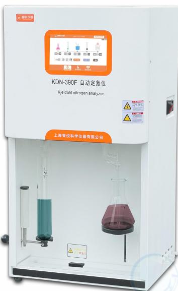
KDN-390F自动定氮仪是依据经典凯氏定氮法设计的样品自动测氮蒸馏装置，该仪器安装、操作简单；测量准确，使用安全、可靠、省时、省力；7寸彩屏操作，一键式启动设计，自动化程度高。广泛应用于粮食、食品、饲料、土壤、肥料、水、沉淀物、化学品、乳制品、酿造、制糖、药物、煤炭、橡胶等物质的粗蛋白质的分析测定，是实验室操作人员的理想工具。
