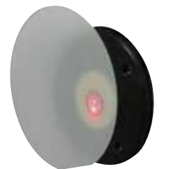
蓝宝石样品：因透明性可观测到两束光的位置。
