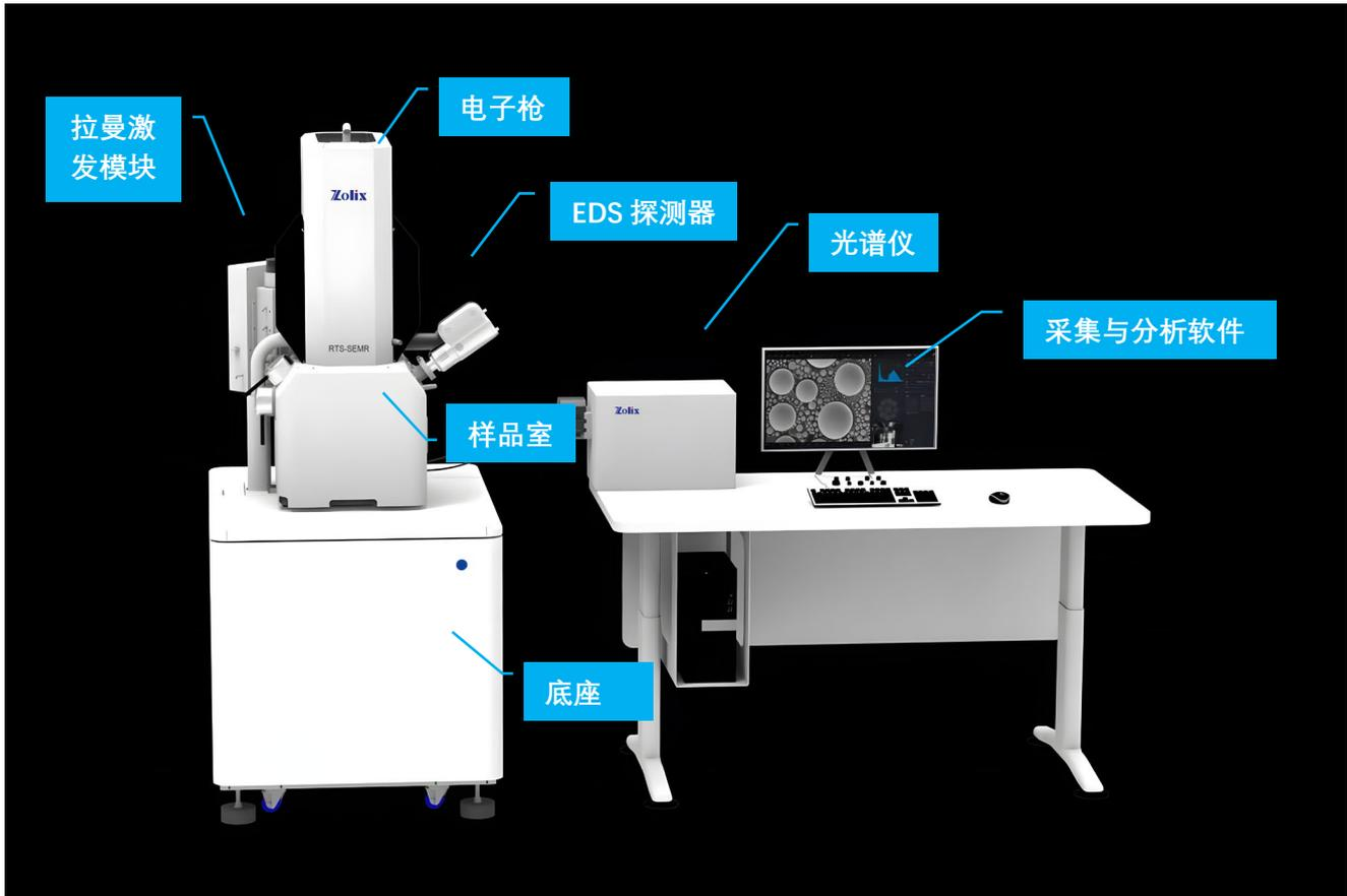
拉曼集成扫描电子显微镜采用平行双束方案，搭载高精度复合位移台可实现样品在拉曼光轴和电子束光轴之间快速、精确、稳定的切换，拉曼扫描范围高达 2.5 mm。
