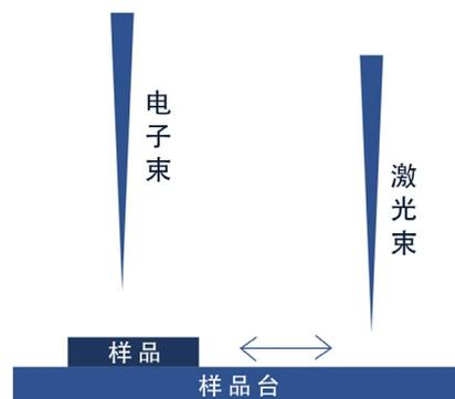
北京卓立汉光仪器有限公司推出的扫描电镜-拉曼光谱联用装置采用“离轴”模式设计理念。“离轴”模式扫描电镜的电子束与拉曼光谱的激光束不同轴, 通过移动样品台分别进行扫描电镜-能谱分析和显微拉曼光谱分析, 原位获取样品指定位置的形貌信息和化学成分信息。
