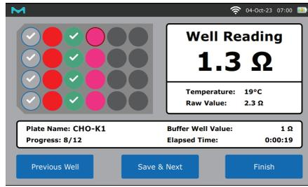
孔板测量屏幕显示孔板地图，便于导航，并显示原始值和背景减去值、所用时间和进度。
