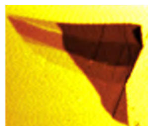
Si 基底上不同层数石墨烯的瑞利散射成像
