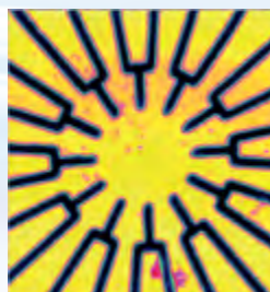
300µm×300µm 区域光电器件的光电流成像
