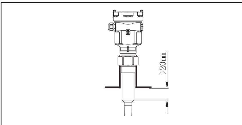
天线的有效部分，即锥形天线部分，必须从容器接管内完全露出来。为适应不同长度的容器接管应用，不同天线长度的雷达物位计可供用户选择。（参看 6 结构尺寸）
