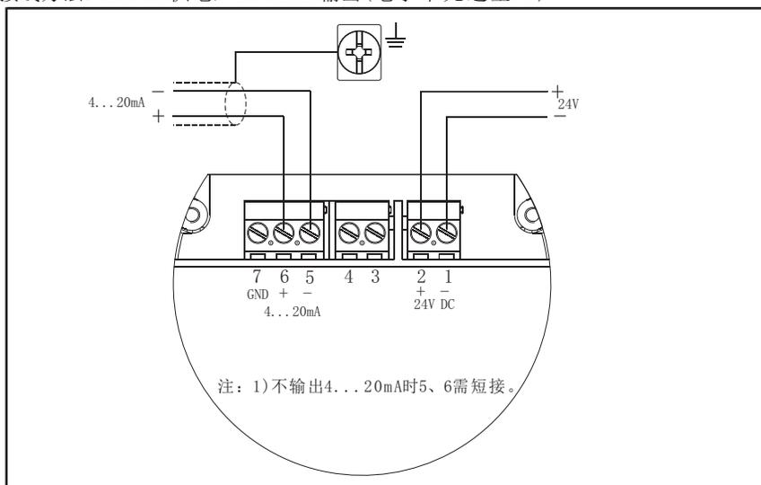
两线(两室): 24V DC供电, 4...20mA输出 (电子单元选型 E)
