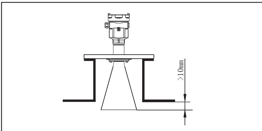
容器接管的长度：必须保证天线伸出接管至少10mm。
