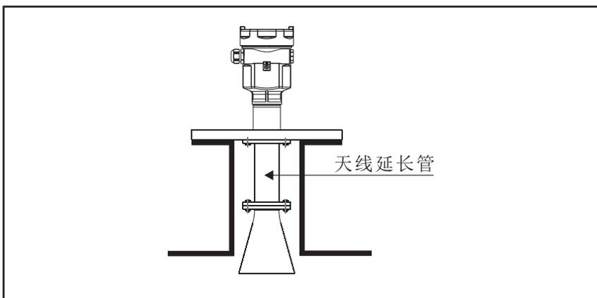
当天线长度小于安装短管长度时，应使用天线延长管。
