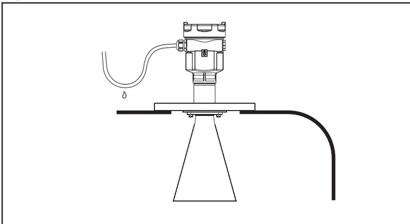
对于安装在室外或潮湿室内及制冷或加热的罐上的仪表，为了防潮，应拧紧电缆密封套，而且要在进线口处使电缆向下弯曲。如图示：
