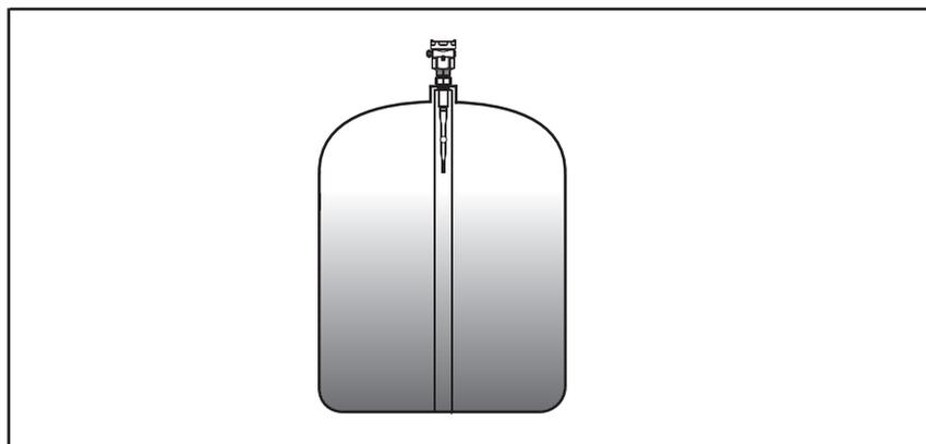
用塑料管做导波管可避免雷达物位计安装在拱顶罐中心处所产生的多次反射现象。当测量的液体是强酸强碱时导波管需用PP或PTFE材质。
