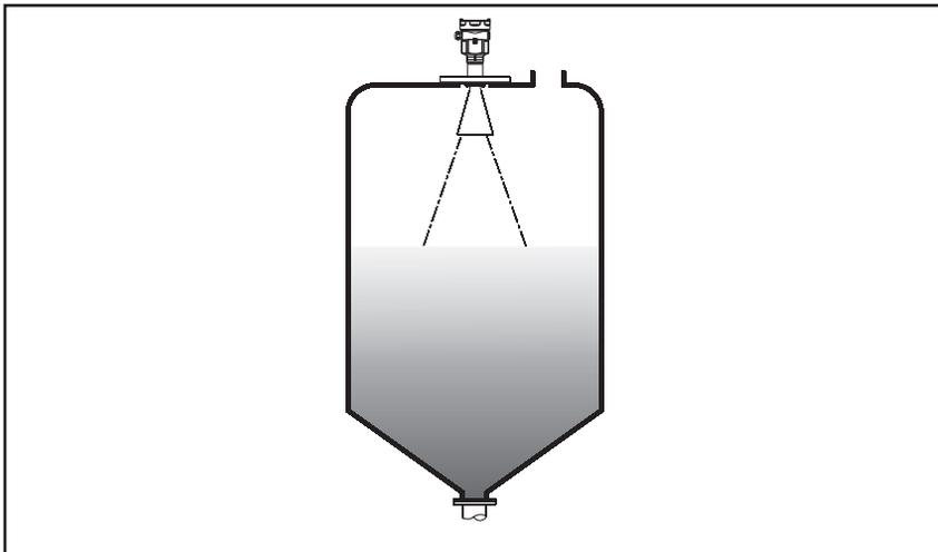
对于锥形容器，且为平面罐顶，仪表的最佳安装位置是容器顶部中央，这样可以保证测量到容器底部。
