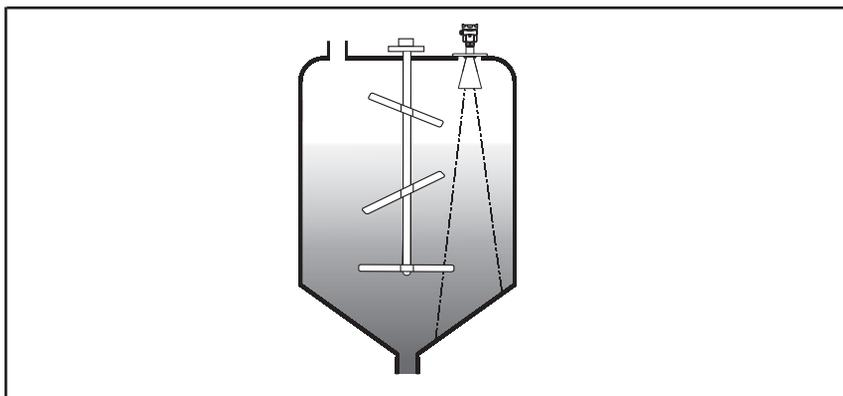
当罐中有搅拌时，仪表安装尽量远离搅拌器。安装后要在搅拌状态下进行“虚假回波学习”，以消除搅拌叶片所产生的虚假回波影响。若由于搅拌产生泡沫或翻起波浪，则应使用导波管安装方式。
