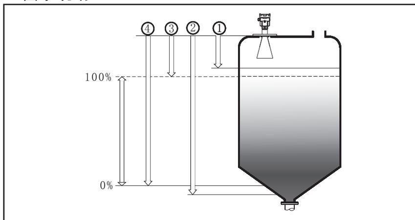
测量的基准面是螺纹或法兰的密封面。
