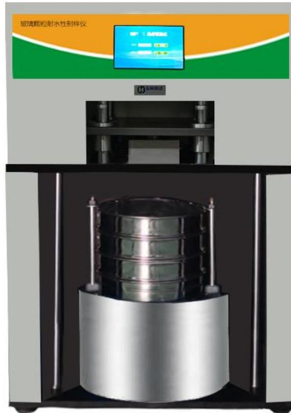
**NSY-01 玻璃颗粒耐水性制样仪**用于输液瓶、注射剂瓶、安瓿瓶、口服液体瓶等药用玻璃制品颗粒耐水性试样制备，通过药用玻璃颗粒耐水性的测试评定样品的耐水浸蚀程度以保证药品或用药安全。
