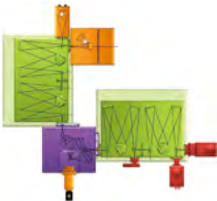
Fluorolog-QM-450-22, 可选配 450 瓦氙灯， 闪烁氙灯，固态近红外检测器，前表面 测量附件，DeltaDiode 激光光源和快速 TCSPC 检测器
