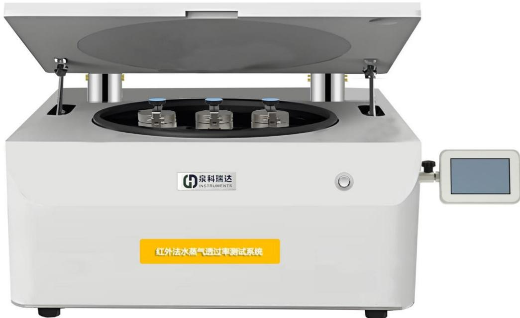
**WVTR-F1 水蒸气透过率测试系统**采用红外水分传感探测水蒸气透过的测试原理，参照 ASTM F1249，ISO 15106-2 等标准设计制造，为高、中气体阻隔性材料提供高精度和高效率的水蒸气透过率测试。适用于食品、药品、医疗器械、日用化学、光伏、电子等领域的薄膜、片材及相关材料的水蒸气透过性能测试。
