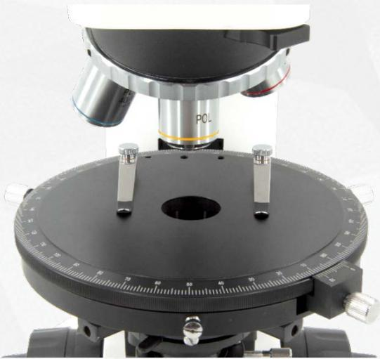
双层旋转式专业偏光载物台，带有 360 度等分刻度，游标格值 6'，中心可调，带锁紧装置和双样品夹，可方便通过偏光度数来确定物质偏光特性。可另加装 XY 移动尺，方便移动观察操作。
