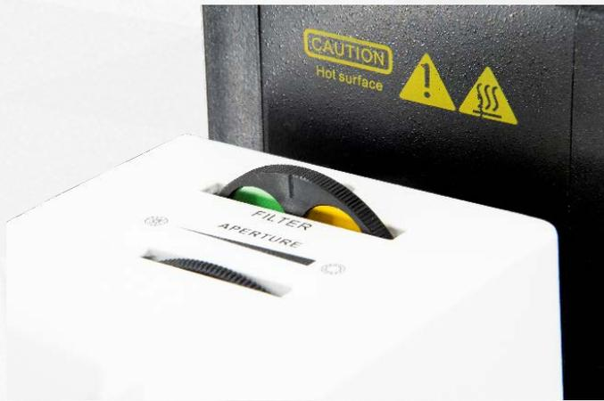
视场光阑、孔径光阑及滤光片分别内置在反射偏光模块里，均采用转轮调节方式，滤光片转轮可装配 3 片滤光片。
