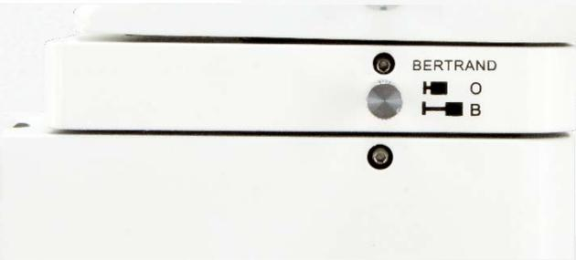
模块化中间接筒勃氏镜安装在观察筒与反射模块间,通过推拉杆选择是否移入勃氏镜,在正交偏光观察锥光偏光观察间快速切换。
