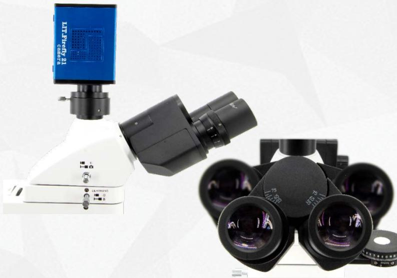
铰链式三目观察筒，30° 倾斜，瞳距 52-75mm，屈光度可调节，可 360° 旋转。可通过成像接口安装显微镜相机，实现数码成像观察。
