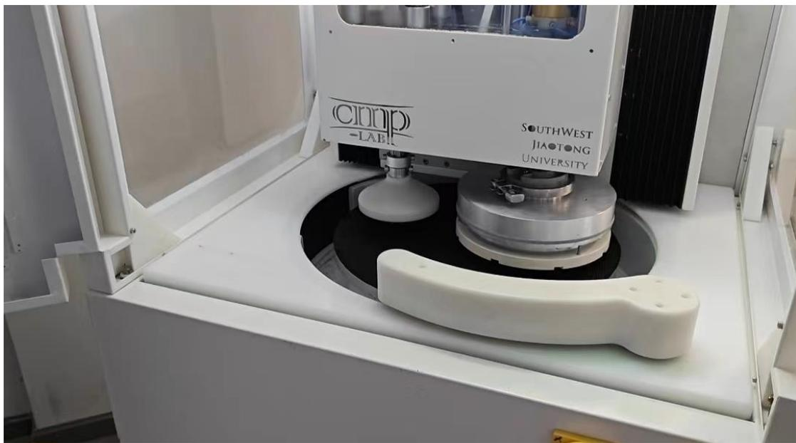
支持存储多种抛光工艺，操作简单便捷，支持 2/4/6 寸产品抛光，可提供常见晶圆加工工艺，24 小时内售后及时响应。
