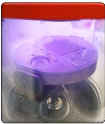
在对样品进行镀膜之前或镀膜之后，可以对样品进行等离子刻蚀处理。使用该附件，可以选择氩气、其它蚀刻气体或大气作为处理气体。这样可以在镀膜前清洁样品，增加薄膜的附着力。也可在样品镀碳后进行等离子处理，从而对碳膜表面进行改性。
