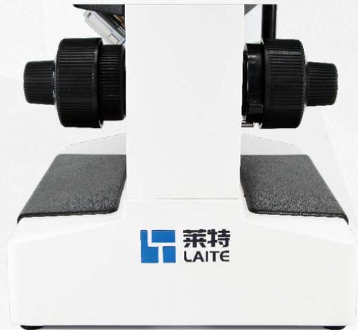
在机身两侧设计抬高的托手台，且向外小幅度倾斜和防滑表面，使用者可以舒适将手腕放在托台上操作。
