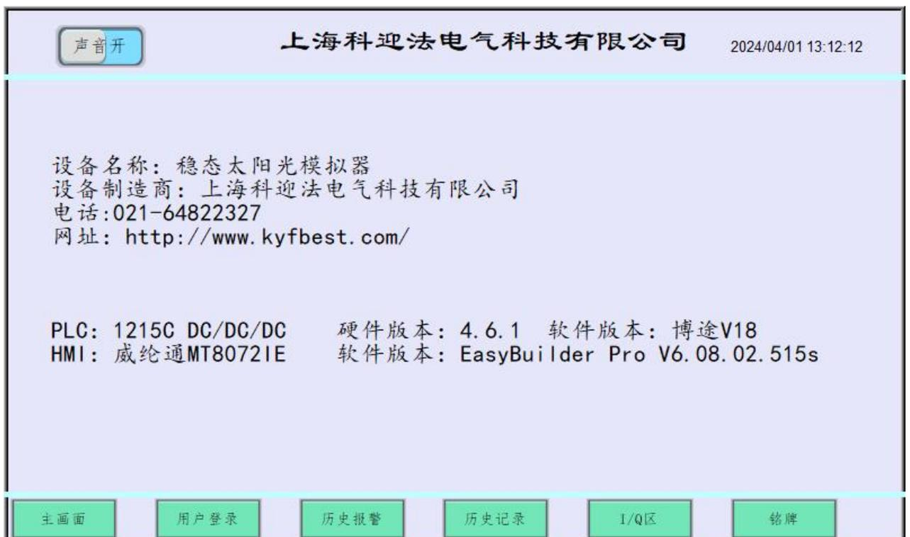
铭牌页面下，屏幕显示设备使用的 PLC 型号、硬件版本号、软件版本号，及 HMI 触摸屏的型号、软件版本号。
