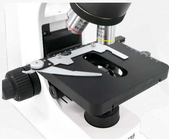
采用双层机械式载物台, 进口丝杠配合齿轮传动, 移动顺畅。
