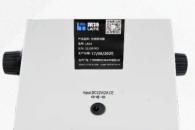
LED 长效照明光源, 预定中心, 无需调节。 亮度连续可调, 光源开关和调节旋钮分别 设计在左右调焦旋钮下侧, 方便操作。 外置式宽电压适配器, 直流 12V2A 供电, 便户外供电使用。
