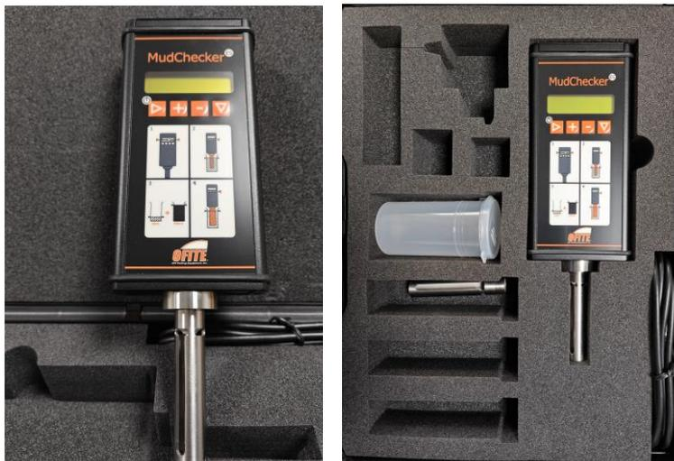
MudChecker 采用当前国际最新技术，提供了一种创新方法用于快速测定油基和其它非水基钻井液中油、水、固相含量及盐度。仪器采用手持式设计，可在短短 3 分钟内提供高精度和可重复性的测试结果，较传统测试方法相比，极大提高了测试效率和操作安全性。
