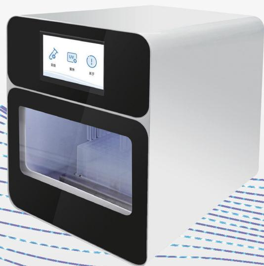
立可LQ-N系列全自动核酸提取仪是一款高效、操作简单、高性价比的核酸自动提取纯化设备。采用磁棒转移磁珠技术，可应用于血液、尿液、拭子、组织匀浆等多种样本的核酸自动提取。只需加入样本，仪器便可按照设定程序运作进行核酸提取，有效减少人为操作误差，节省80%以上人力。完美匹配小型实验室核酸提取需求。
