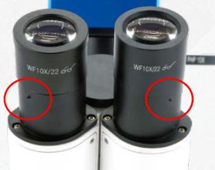
设置目镜锁定螺丝，可以对目镜进行定位锁住，防止目镜被灰尘等颗粒污染或掉落。
