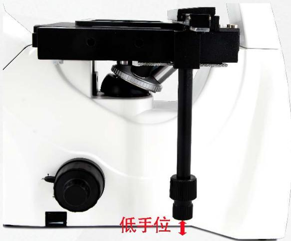
柔性 X/Y 轴低手位移动手柄与调焦手轮基本在同一高度，操作间隔距离空间充足，互不干扰，使移动及调焦操作更加方便舒适。
