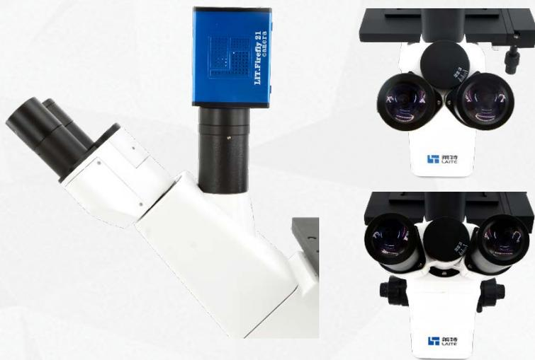
铰链式三目观察筒，45° 倾斜，瞳距 55-75mm 屈光度可调节。
