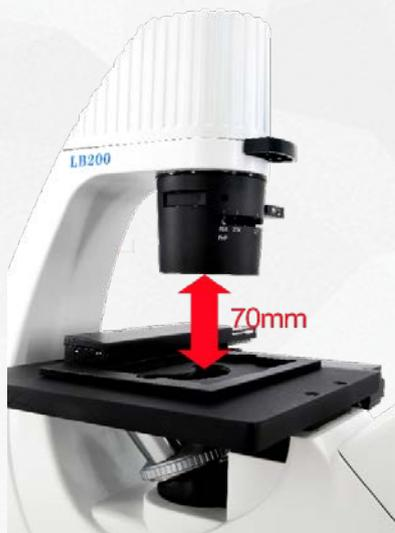
聚光镜工作距离长达 70mm,并可拆卸长卸，当拆下聚光镜后纵向空间可  $\geq$  150mm，足够宽的空间为大型细胞培养皿提供观察，如细胞工厂的观察。
