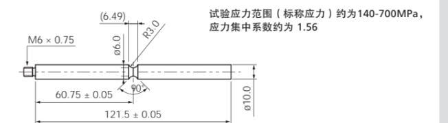
\*软件可测量试验样品尺寸并计算应力。
